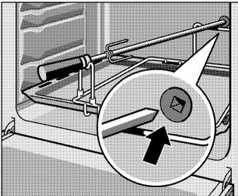
3. Enfourner la plaque à pâtisserie émaillée au niveau 1 jusqu'en butée. Dans la paroi arrière du four se trouve un orifice. Le tournebroche doit y être engagé.
