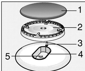
Nettoyer le capot des becs (1) et le corps des becs (2) avec de l'eau et du détergent de vaisselle. Sécher parfaitement les pièces.
