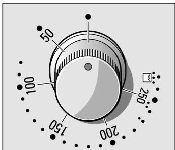
Le thermostat permet de régler la température ou la position gril. Tournez le thermostat uniquement à droite.
