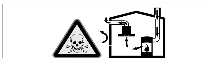
Zależne od powietrza w pomieszczeniu urządzenia spalające (np. grzejniki na gaz, olej, drewno lub węgiel, przepływowe podgrzewacze wody i inne podgrzewacze wody) pobierają powietrze do spalania z pomieszczenia, w którym się znajdują, a
