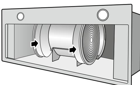
**4.** Zamontować metalowe filtry przeciwłuszczowe.
