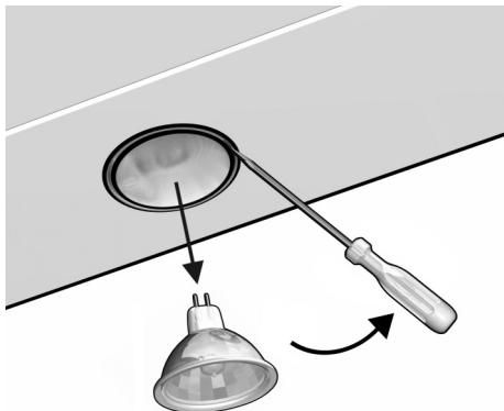
**Huom.:** Laite saattaa vaurioitua irrotettaessa lamppu huolimattomasti.
