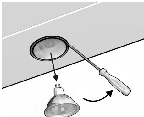
**Uwaga:** w przypadku niepoprawnego odkręcenia, istnieje możliwość uszkodzenia urządzenia.
