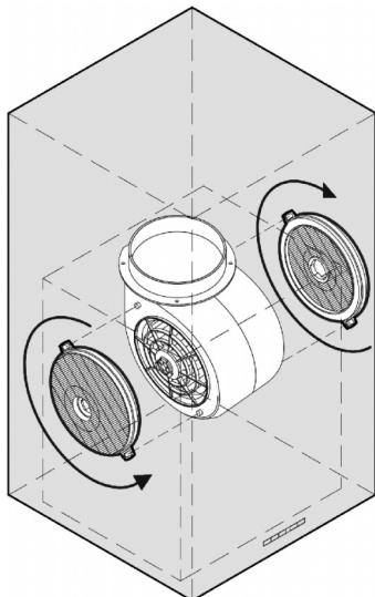
3. Drei filtrene i pilens retning inntil de smekker i. Dersom de er riktig montert, lar de seg ikke trekke av igjen.
