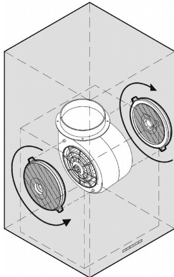
3. Vrid filtren i pilens riktning tills de sitter fast. Filten är rätt monterade när de inte längre går att dra av.
