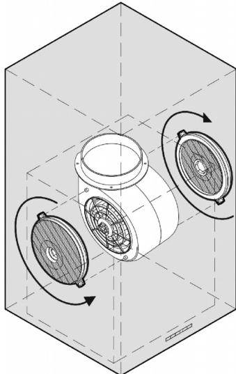
3. Tournez les filtres dans le sens de la flèche jusqu'à ce qu'ils encrantent. Une fois les filtres correctement montés, ils sont impossibles à enlever.
