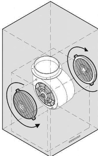
3. Käännä suodattimia nuolen suuntaan, kunnes ne napsahtavat kiinni. Kun suodattimet ovat oikein paikoilleen, ei niitä voi enää vetää irti.
