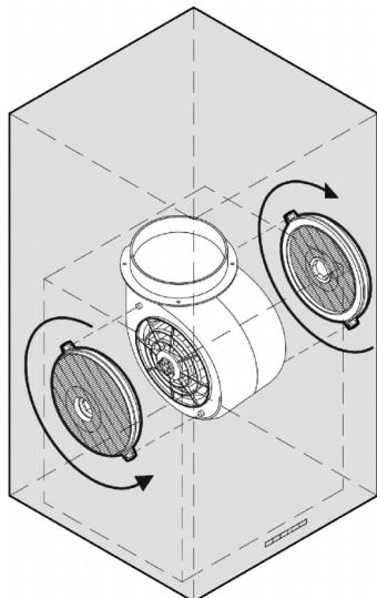
3. Drejfiltrene i pilens retning, til de falder i hak. Er filtrene monteret rigtigt, kan de ikke mere fernes.
