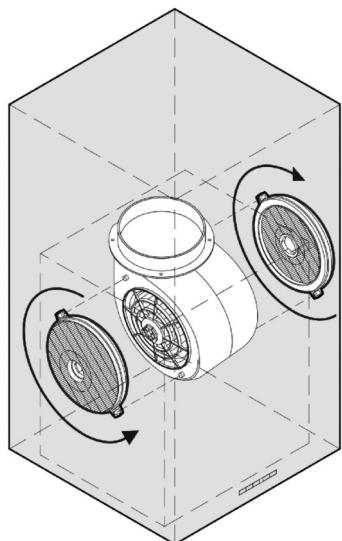
3. Przekrącić filtry zgodnie z kierunkiem strzałki do momentu ich zaczepienia. Filtry zamontowane poprawnie nie mogą być usunięte.
