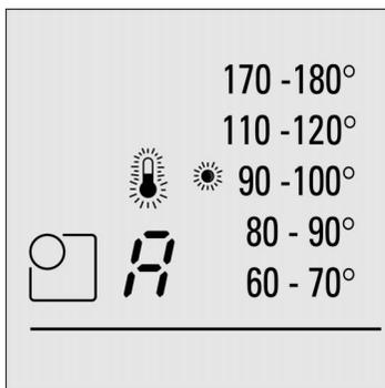
2. Aan de aan- / uitschakelaar draaien, totdat het indicatielampje naast het gewenste temperatuurbereik brandt. Op het display verschijnt een A. De kooksensor is geactiveerd.
