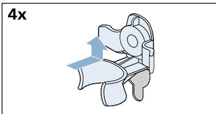
a) Clipsez solidement les flexibles sur les supports.
