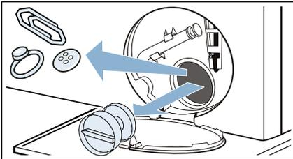
5. Replacez et vissez le couvercle de la pompe. La poignée doit se trouver en position verticale.
