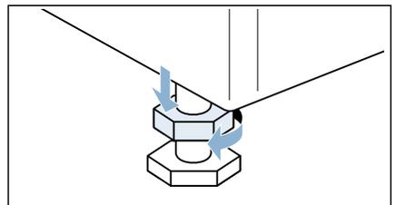
2. Vérifiez l'alignement de l'appareil avec un niveau à bulle et modifiez-le si nécessaire. Modifiez la hauteur en tournant les pieds de l'appareil. Les quatre pieds de l'appareil doivent reposer fermement sur le sol.
