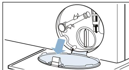
3. Retirez le tuyau de vidange de sa fixation. Retirez le capuchon d'étanchéité et videz l'eau dans un récipient approprié. Remplacez le capuchon d'étanchéité et remettez le tuyau de vidange dans la fixation.
