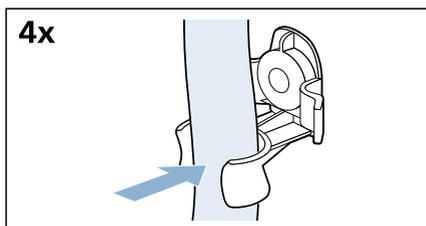
b) Clipsez solidement le câble d'alimentation sur les supports.
