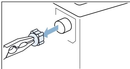
4. Rattachez le tuyau de vidange et sécurisez le point de raccordement à l'aide du collier de serrage.
