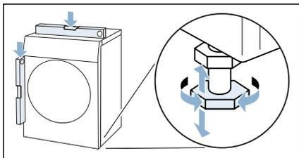
3. Serrez l'écrou de blocage contre la carrosserie. En faisant cela, maintenez le pied serré et ne modifiez pas sa hauteur. Les contre-écrous des quatre pieds de l'appareil doivent être fermement vissés contre la carrosserie.
