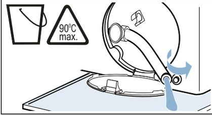
4. Dévissez prudemment le couvercle de la pompe ; de l'eau résiduelle risque de s'écouler. Nettoyez l'intérieur, le filet du couvercle de pompe et le corps de pompe. Le rotor de la pompe de vidange doit pouvoir tourner librement.
