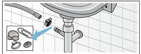
4. Remmanchez le flexible d'écoulement et sécurisez le point de raccordement à l'aide du collier du flexible.
